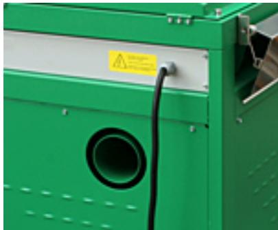
Serienmäßig eingebauter Anschluss für eine Absaugvorrichtung
