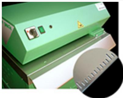
**Bedienfreundlicher Zufürtisch mit gestanzter Maß-Skala für genaue Verpackungseinheiten**
