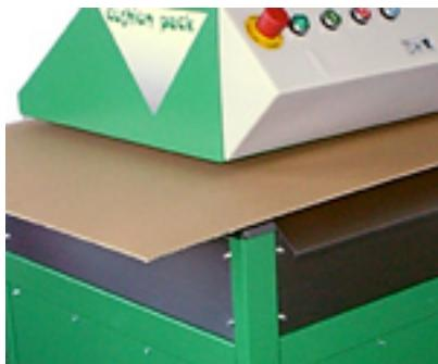
**Die Kartonagen jeder Größe werden automatisch abgeschnitten. Zusätzliches vorschneiden entfällt.**
