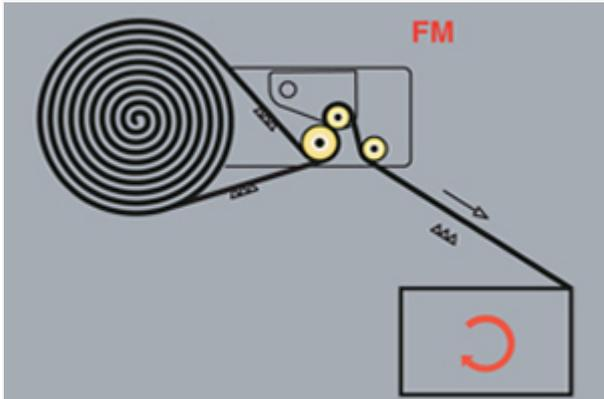
FM - Standard TYP "FM" mit mechanischer Bremse Die Bremskraft ist manuell am Folieschlitten einstellbar.
