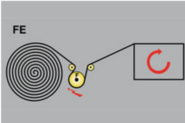
FE Eine Walze wird elektromagnetisch gebremst. Die Bremskraft ist an der Bedieneinheit einstellbar.
