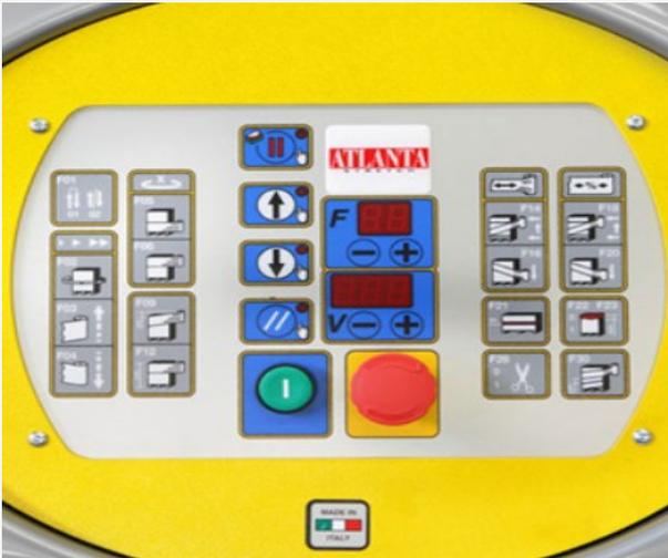
einfache Bedieneinheit • Anzahl der Fußwicklungen • Anzahl der Kopfwicklungen • Geschwindigkeit des Hubmastes • Geschwindigkeit des Roboters • freie Programmierung
