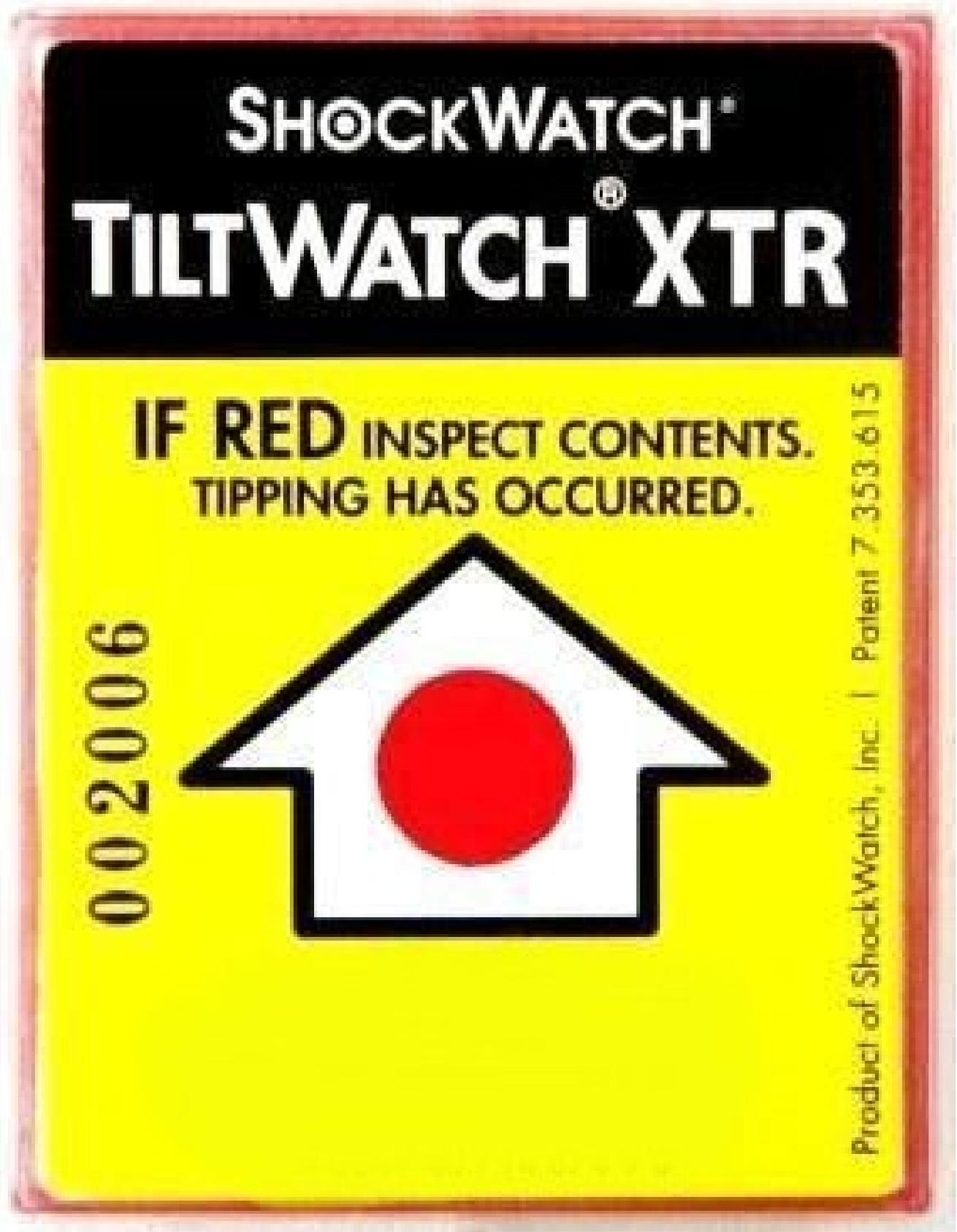
TiltWatch XTR ist mit einer Schutzfolie gesichert und kann erst mit/nach Aufbringung am Versandgut ausgelöst werden. Das
